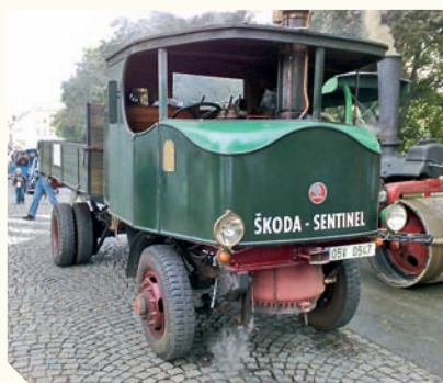
Лицензионный паромобиль ŠKODA Sentinel развивал мощность до 70 л.с. Он выпускался в нескольких модификациях грузоподъемностью от 5 до 7 тонн. На шасси Sentinel строились машины различного назначения, включая автобусы
